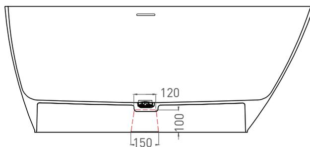
\* Расположение стандартного технического отверстия на задней стенке. В базовую комплектацию не входит, заказывается отдельно.
